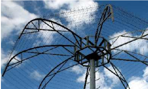
반구형 어레이(Hemisphere Array) 지지폴, 건물상단,타워등을 이용하여 산업용시설이나 일반 상용 시설에 적용 가능.
